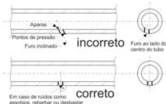
Fig. 25 Execução dos orifícios de aspiração
