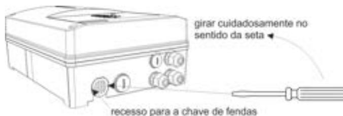
Fig. 17 Remoção do tampão do tubo de saída de ar
