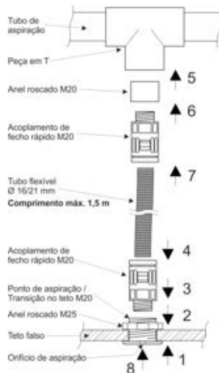
Fig. 28 Montagem da transição no teto
